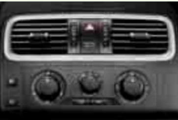
Poloautomatická klimatizace Climatic: automatické udržování nastavené teploty vhněného vzduchu, manuální regulace množství vzduchu a nastavení výdechů. Standardně pro výbavové verze Sport a Elegance, pro Classic a Ambiente na přání.
