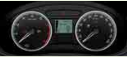
Kombi přístroj s palubním počítačem, standardně od verze Ambiente.
