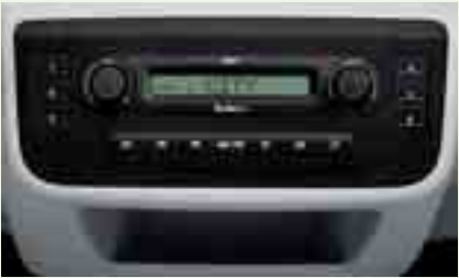
Rádio Beat: rádiový přijímač AM/FM se systémem RDS, elektronické komfortní kódování zaručující funkčnost rádia jen v konkrétním voze, funkce ovládání CD měniče a vstup pro připojení hands-free sady. V nabídce vždy s audiozdiřkou.
