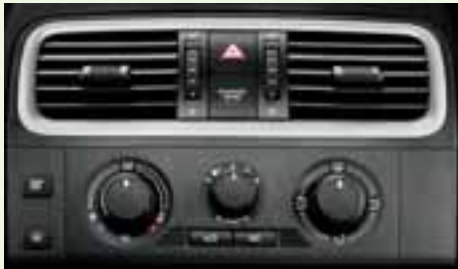
Climatic – klimatizace s automatickou regulací a kombifiltrem: automatické udržování nastavené teploty vlněného vzduchu, manuální regulace množství vzduchu a nastavení výdechů. Standardně pro vybavení verze Sport a Elegance, pro verze Classic a Ambiente na přání.
