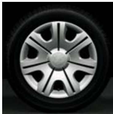
Kola ocelová 6,0J x 14" (pneu 185/60 R14) s velkoplošnými kryty kol Tethys
