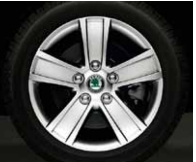
Octavia, Octavia Combi: kola z lehké slitiny Pyxis 6,5J x 15" (pneu 195/65 R15 s nižším valivým odporem)
