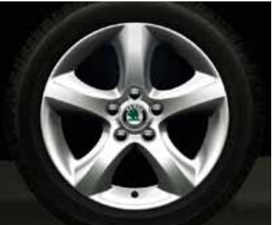
Fabia, Fabia Combi, Roomster: kola z lehké slitiny Antares 6,0J x 15" (pneu 185/60 R15 s nižším valivým odporem)
