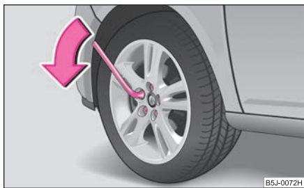
Obr. 172 Výměna kola: povolení šroubů
