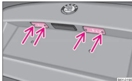
Obr. 190 Demontáž osvětlení registrační značky
