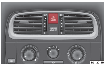
Obr. 50 Přístrojová deska: spínač varovných světel
