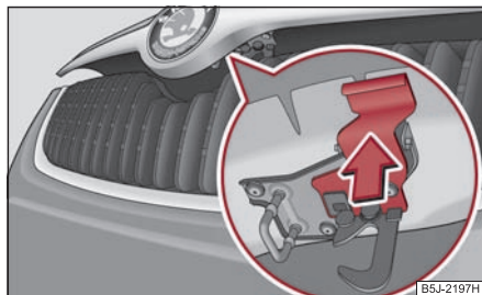
Obr. 15 Mřížka chladiče: páka pojistky
