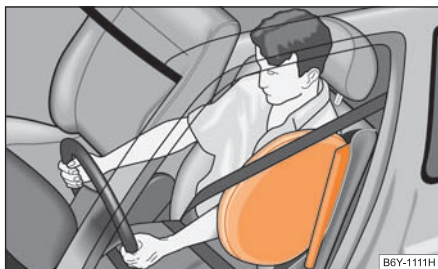
Obr. 150 Aktivovaný boční airbag
