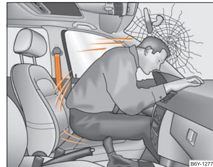
Obr. 139 Nepřipoutaný řidič je vržen dopředu
