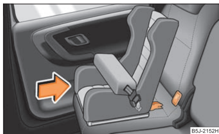
Obr. 163 Dětská sedačka ISOFIX se zasune do montážních krytů
