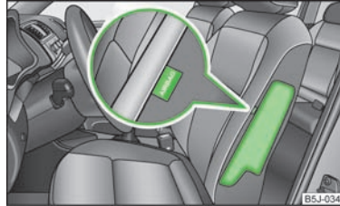
Obr. 99 Umístění bočních airbagů v sedadle řidiče
