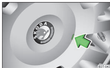
Obr. 126 Stažení ozdobného krytu u kol z lehkých slitin
