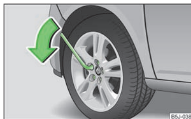
Obr. 130 Výměna kola: povolení šroubů
