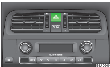
Obr. 25 Přístrojová deska: spínač varovných světel
