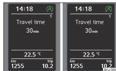
Obr. 118 Displej MAXI DOT: motor je automaticky vypnutý / automatické vypnutí motoru není možné
