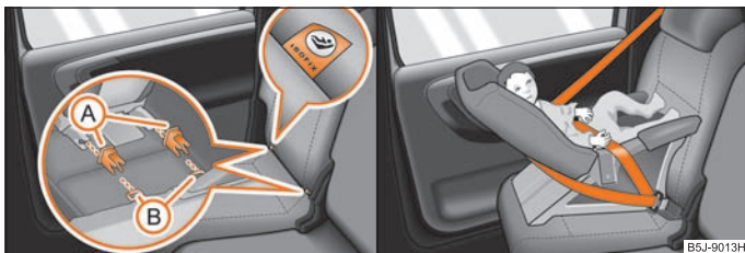
Obr. 124 Upevňovací oka (systém ISOFIX) / Dětská sedačka ISOFIX se zasune do montážních krytů
