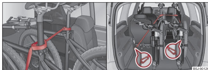
Obr. 69 Zajištění kol objímkami / popruhem
