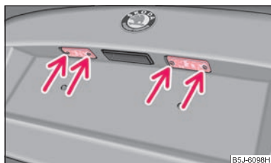
Obr. 169 Demontáž osvětlení registrační značky
