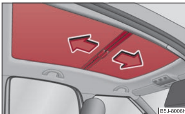
Obr. 33 Panoramatická střecha: odkrytí sluneční clony
