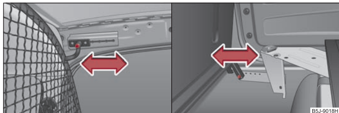
Obr. 176 Horní úchyt / spodní úchyt bezpečnostní přepážky
