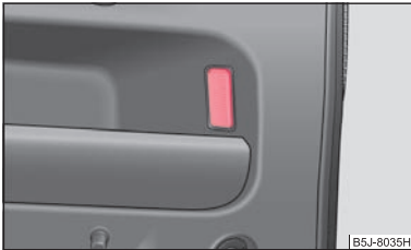
Obr. 172 Demontáž osvětlení zavazadlového prostoru
