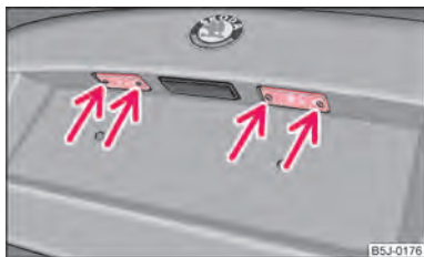
Obr. 159 Demontáž osvětlení registrační značky
