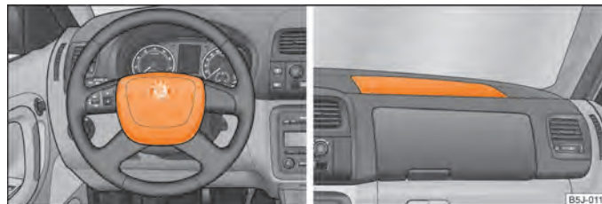
Obr. 97 Airbag řidiče ve volantu / Airbag spolujezdce v přístrojové desce
