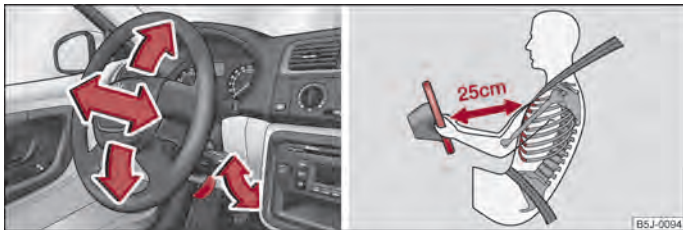
Obr. 77 Nastavitelný volant: páčka pod sloupkem řízení / Bezpečná vzdálenost od volantu
