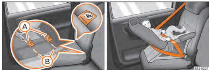
Obr. 111 Upevňovací oka (systém ISOFIX) / zasunutí dětské sedačky do montážních krytů
