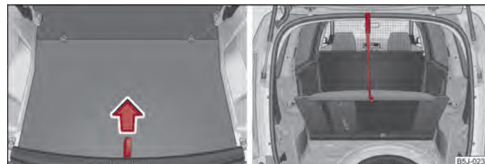
Obr. 164 Poutko pro zvednutí podlahy / Upevnění podlahy pomocí plastového háčku
