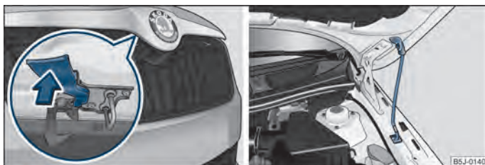
Obr. 122 Mřížka chladiče: páka pojistky / Zajištění víka motorového prostoru vzpěrou
