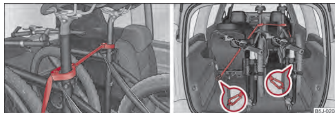
Obr. 56 Zajištění kol objímkami / Zajištění kol popruhem
