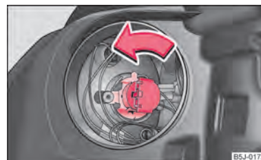
Obr. 155 Demontáž žárovky dálkového světla
