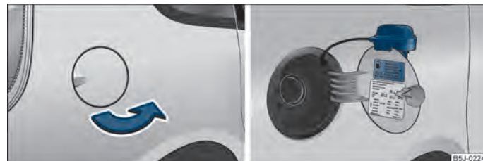
■ Obr. 120 Boční strana vozidla vpravo vzadu: kryt hrdla / Kryt hrdla palivové nádrže s odšroubovaným uzávěrem
