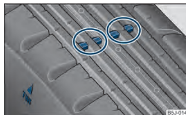
Obr. 131 Dezénové drážky pneumatiky s ukazateli opotřebení
