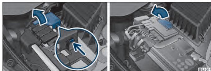
Obr. 127 Akumulátor: odklopení krytu (automatická převodovka) / (mechanická převodovka)
