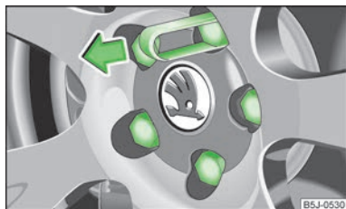
Obr. 125 Stažení krytky šroubu kola
