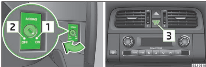
Obr. 103 Vypínač čelního airbagu spolujezdce / Kontrolní světlo vypnutého airbagu spolujezdce
