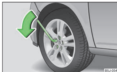
Obr. 130 Výměna kola: povolení šroubů
