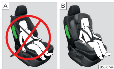
Obr. 16 Nesprávně zajištěné dítě na sedadle v poloze, ve které je ohroženo bočním airbagem / Správně zajištěné dítě v dětské autosedačce
