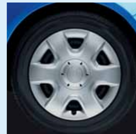
Kola ocelová 6,0J x 15" (s pneumatikami 195/55 R15) s velkoplošnými kryty kol Hermes .
