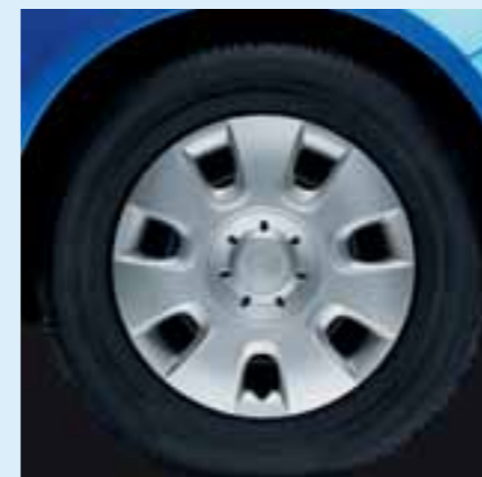
Kola ocelová 5,0J x 14" (s pneumatikami 175/70 R14) s velkoplošnými kryty kol Draco .
