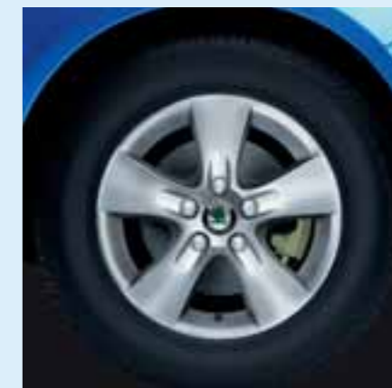
Kola z lehké slitiny Atik 6,0J x 14" (s pneumatikami 185/65 R14).
