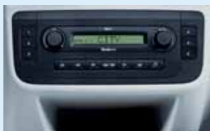
Rádio Beat: rádiový přijímač AM/FM se systémem RDS, elektronické komfortní kódování zaručující funkčnost rádia jen v konkrétním voze, funkce ovládání CD měniče a vstup pro připojení hands-free sady. V nabídce vždy s audiodírkou.
