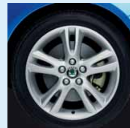
Kola z lehké slitiny Atria 6,5J x 16" (s pneumatikami 205/45 R16).
