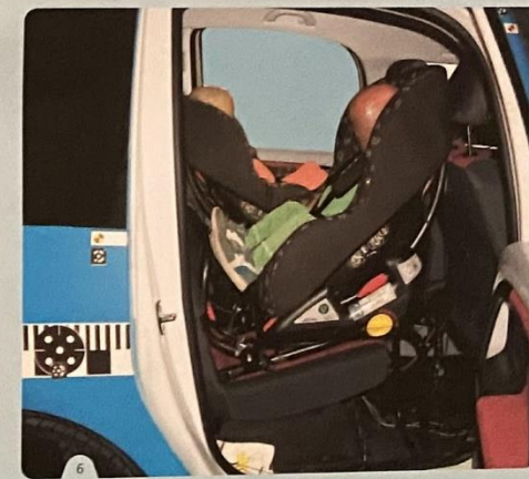
6. Originální dětské autosedačky musí před schválením a zařazením do sortimentu příslušenství projít náročnými zkouškami včetně tzv. crash testů za použití dětských figurín.
