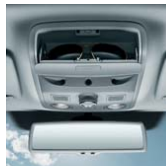
Schránka na brýle umístěná ve stropním panelu.
