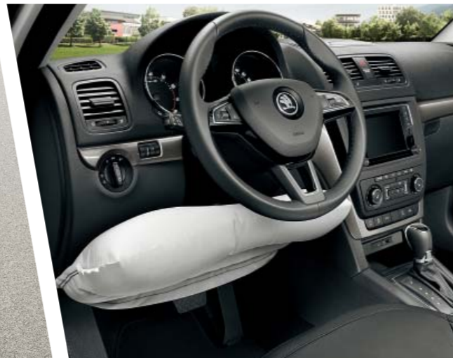
Kolenní airbag řidiče chrání v případě nárazu před kontaktem se spodní částí přístrojové desky.
