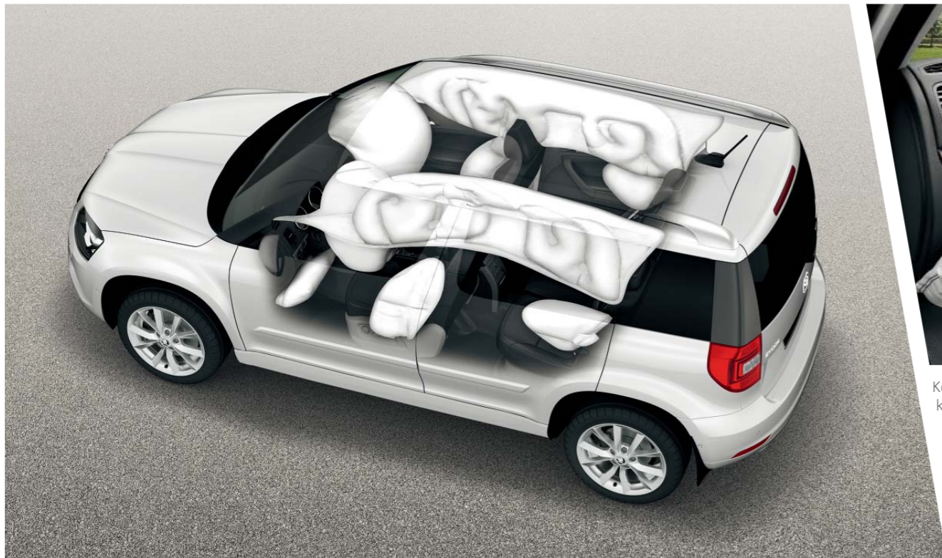
Hlavové airbasy, které vytvoří po aktivaci stěnu před bočními okny, chrání hlavy cestujících vpředu i vzadu.
