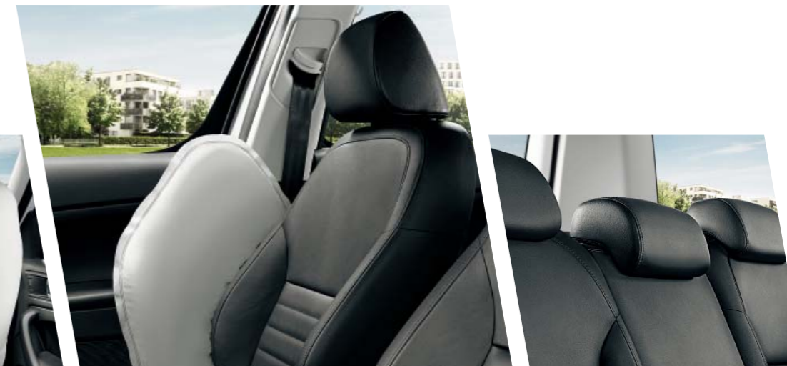
Třetí hlavová opěrka vzadu, výškově stavitelná, zvyšuje bezpečnost cestujícího na prostředním sedadle.
