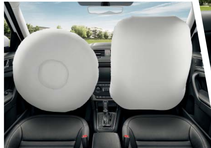
Zatímco airbag řidiče je ukrytý ve volantu, v přístrojové desce se nachází airbag spolujezdce. Ten lze v případě potřeby deaktivovat, takže je možné umístit na přední sedadlo dětskou autosedačku.
